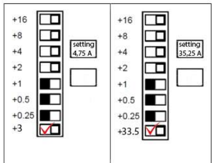
DDMP-65 (Esempio di settaggio a 35,25A)
