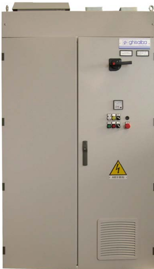
Quadro avviatore ad inverter con by-pass (basso contenuto armonico in rete THDI<3%) per pompa antincendio: 440V-153kW-249A
