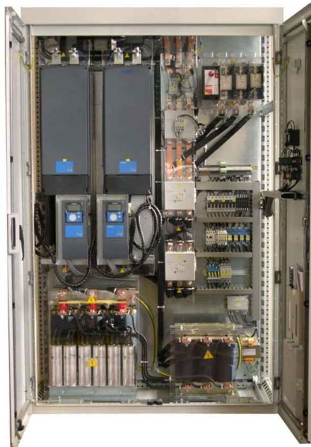
Quadro avviatore ad inverter con by-pass (basso contenuto armonico in rete THDI<3%) per pompa antincendio: 440V-153kW-249A
